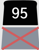
c. 样品座与主机未扣合的情况下，主机电池图标会显示 "X"。
